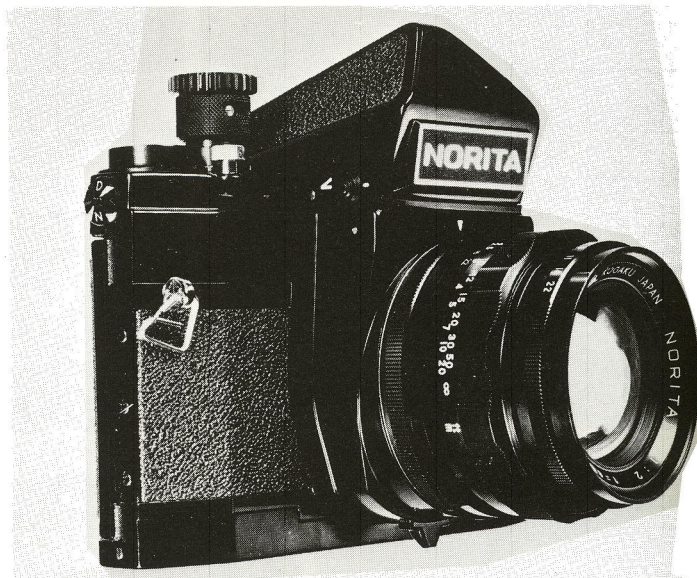
Norita 6x6 med spaltelukker 1-1/500 sek., her med prismesøger og den lysstærke normaloptik 80 mm/f:2.
